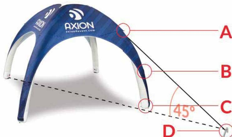
2. Am Zelt sind standardmäßig Abspannseile angebracht (Punkt A). Diese Seile müssen mit Erdheringen verankert werden. Der optimale Winkel der Erdherige zum Boden beträgt  $45^\circ$ . Der optimale Winkel der Seile liegt in diagonaler Linie ( $45^\circ$ ) zum Zelt.
